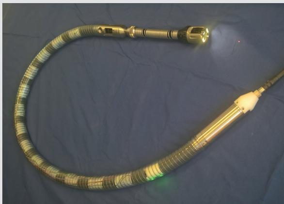
**Bild 1:** Wasserschlange mit Schwenkkopfkamera, Ortungssender, Hydrofon, Mikrofon, Batterien in Druckschlauch und LWL-Stecker
