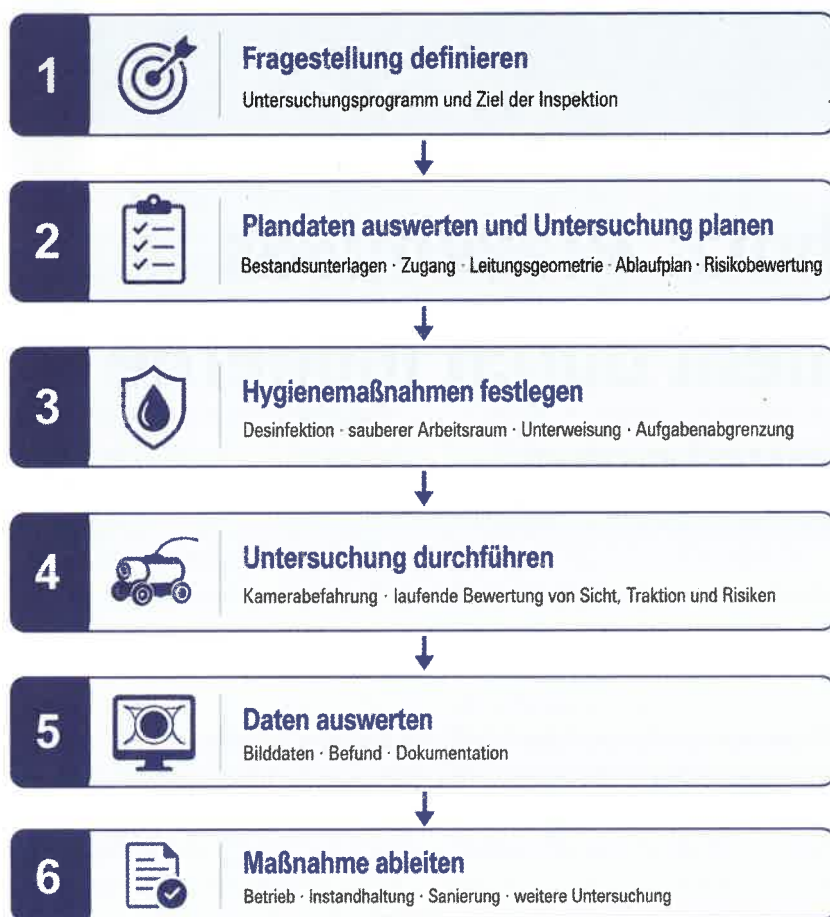
Bild 3: Schema für den Ablauf einer Kamerainspektion (Bild mit KI-Unterstützung)
