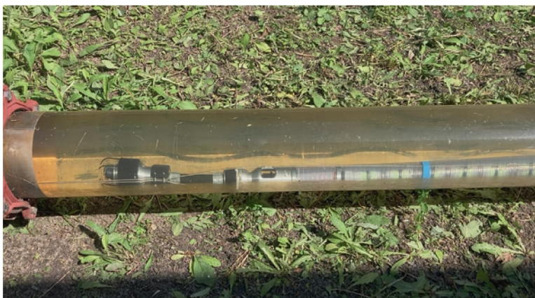
Abb. 3: Untersuchungen mit der Wasserschlange am Versuchsnetz
