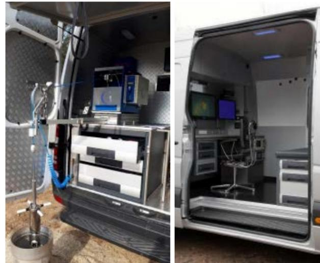
**Bild 2: Brunneninspektionsfahrzeug im Einsatz: Geräte- und Operatorraum (l.) und Operatorraum (r.)**
